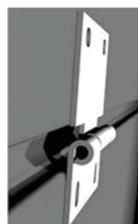
5.- Les linteaux réduits de 160 mm et 200 mm, seront assemblés avec le support de galet montrés ci-dessous
