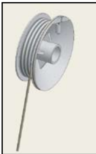
Fig.19. Ajuste del cable de acero trenzado al tope del tambor
